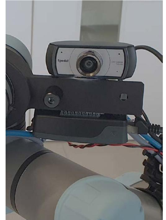
Verwendete 2D/3D Sensoren am Arm des Roboters.
